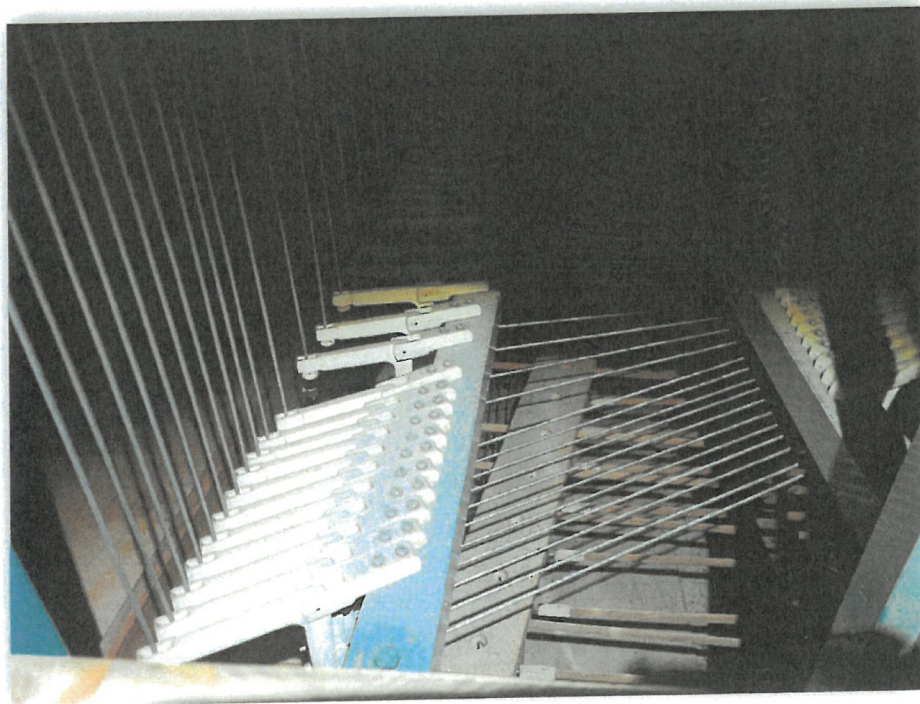
Bild 2 – Blick auf einen kleinen Teil der Trakturwinkel aus Kunststoff.
